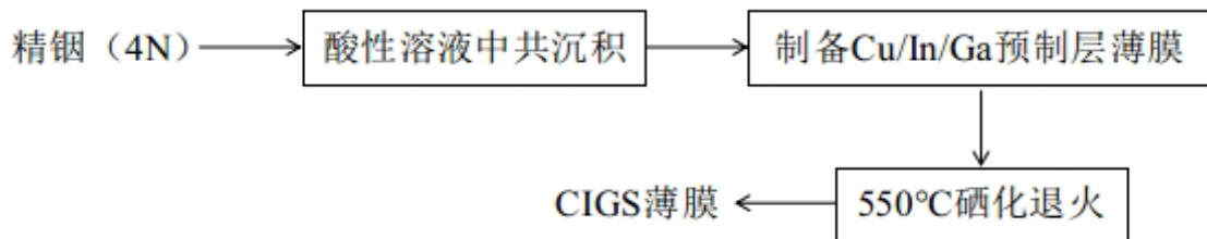
图 4-4 铜铟镓硒太阳能薄膜电池基础工艺流程
